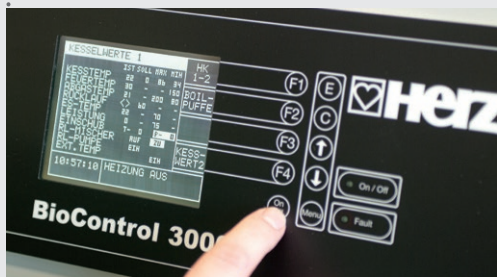
Aansturing BioControl 3000 (bij de firestar18)
