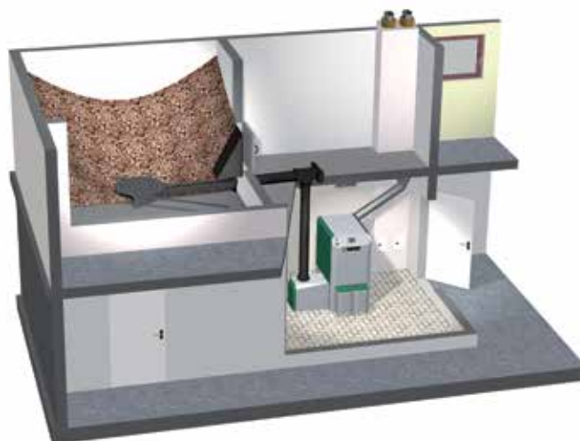
Brandstofopslag en stookruimte op verschillend niveau. Horizontaal brandstoftoevoer door roerwerk met veerarmen en valschacht.
