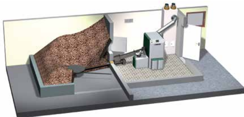
Brandstoftoevoer d.m.v. horizontaal roerwerk met veerarmen en transportvijzel voor een optimaal gebruik van de voorraadbunker
