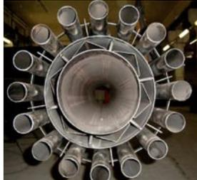
Kessel bis 150 kW werden mit stehenden Rauchzugrohren geliefert. Für Rohrreinigung und optimalen Wärmeübergang sorgen flexible Turbulatoren.
