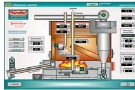
Bei der Visualisierung\* werden die Anlagenparameter am Computer ein- und ausgegeben. Grafische Schaubilder verdeutlichen die Zusammenhänge. Zusätzlich können Daten eines längeren Zeitraums aufgezeichnet und ausgewertet werden. Fernabfrage via Modem ist möglich.
