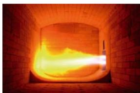
**EBF** – Einblas-Feuerung mit Schnecken-Beschickung
