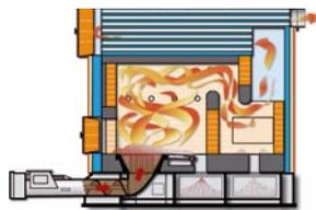
**RRF** – Retortenrost-Feuerung mit Schnecken-Beschickung
