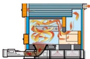
**PRF** – Pellets-Retorten-Feuerung mit Schnecken-Beschickung
