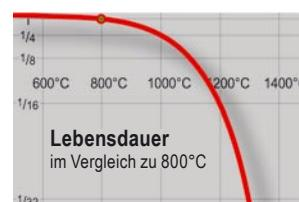
Durch das größere Volumen von Rauchgas – bezogen auf den gleichen O<sub>2</sub>-Gehalt – wird mehr Hitze aus dem Brennraum an den Wärmetauscher abgeführt. Niedrigere Temperaturen erhöhen die Lebensdauer von Schamottierung und Rost.
