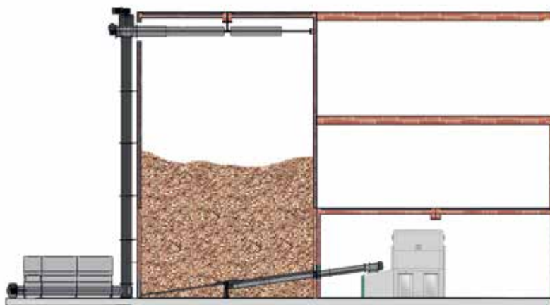
De opslagruimte bevindt zich naast de stookruimte
