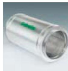
Die **Rohrschalldämpfer** werden vorzugsweise druckseitig dem Ventilator nachgeschaltet. Luftschall wird in diesem Bauteil um bis zu 5 dB(A) reduziert. Die Rohrschalldämpfer haben eine äußere Hülle aus sendzimirverzinktem Stahlblech und sind innen mit schalldämmenden Materialien und Einlagen ausgerüstet. Die Baulänge beträgt ca. 1000 mm.
