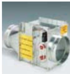
■ **Feuersicherungsklappen.** Führt eine Abaugleitung/ Förderleitung durch eine Brandwand oder eine als solche ausgewiesene Decke, muß sie mit einer Absperrrichtung gegen Brandübertragung ausgerüstet sein. Die Schuko-Feuersicherungsklappen erfüllen diese, im VDMA Einheitsblatt 24179 Teil 2 gestellten Forderungen. Es wird unterschieden zwischen Feuersicherungsklappen zum waagerechten und senkrechten Einbau.
