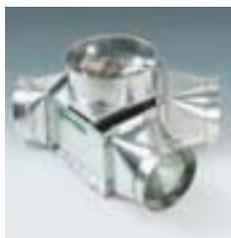
■ **Rohrweichen.** Verzweigen Rohrleitungen, wie z.B. bei der wechselweisen Beschickung von Silos oder Containern, werden in materialführenden Leitungen Rohrweichen eingesetzt. Die Verstellung wird von Hand, möglichst bei Anlagenstillstand, vorgenommen. Die Bauform ist serienmäßig symmetrisch der Abbildung entsprechend, mit zwei Abzweigungen jeweils unter 22,5° zur Mittelachse.
