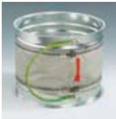
■ **Kompensatoren** sind elastische Verbindungsstücke in fest verlegten Rohrleitungen. Diese „Unterbrechungen“ reduzieren die Übertragung von Schwingungen und Körperschall im Rohrsystem. Schallwellen, die von den metallischen Rohrleitungen über weite Strecken transportiert werden, finden im Kompensator eine Unterbrechung und werden nur noch reduziert weitergeleitet.
